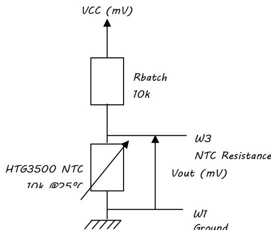
$$V_{out} (mV) = \frac{V_{cc} (mV) * NTC_{HTG3500} (\Omega)}{R_{batch} (\Omega) + NTC_{HTG3500} (\Omega)}$$
