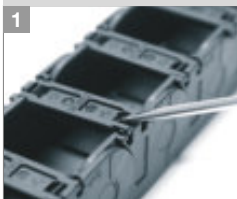
1 Stege aufhebeln und aufschwenken
