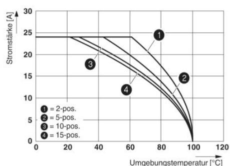
Abbildung zeigt die Deratingkurve der Klemme UT 2,5/1P... in Verbindung mit den Stecker UPBV 2,5
