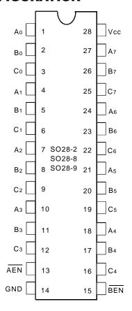
SOIC/ QSOP/ TSSOP TOP VIEW
