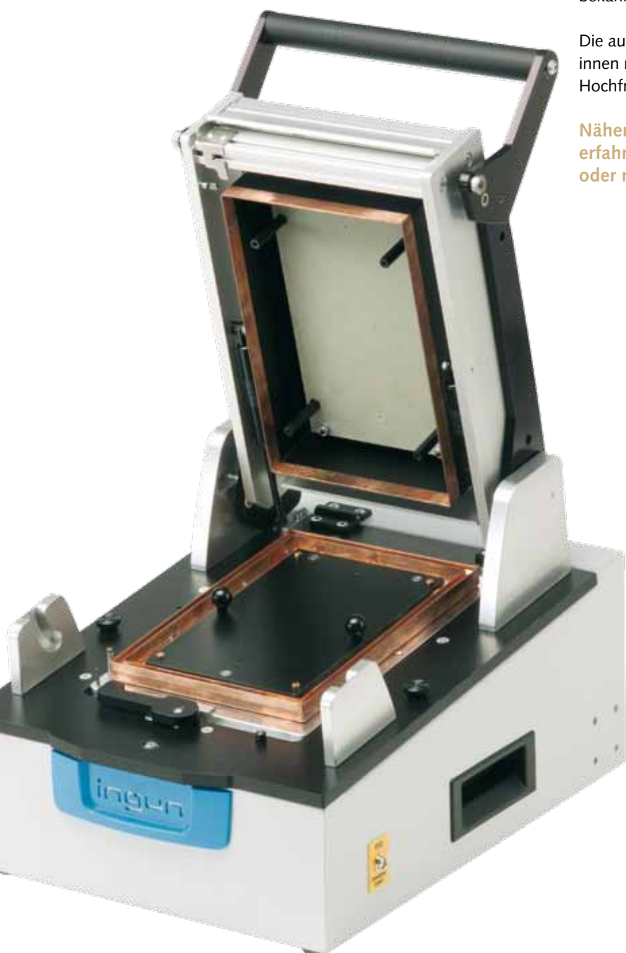
Hochfrequenz-Prüfadapter auf Basis MA 2111 mit ATS 2111/HF
