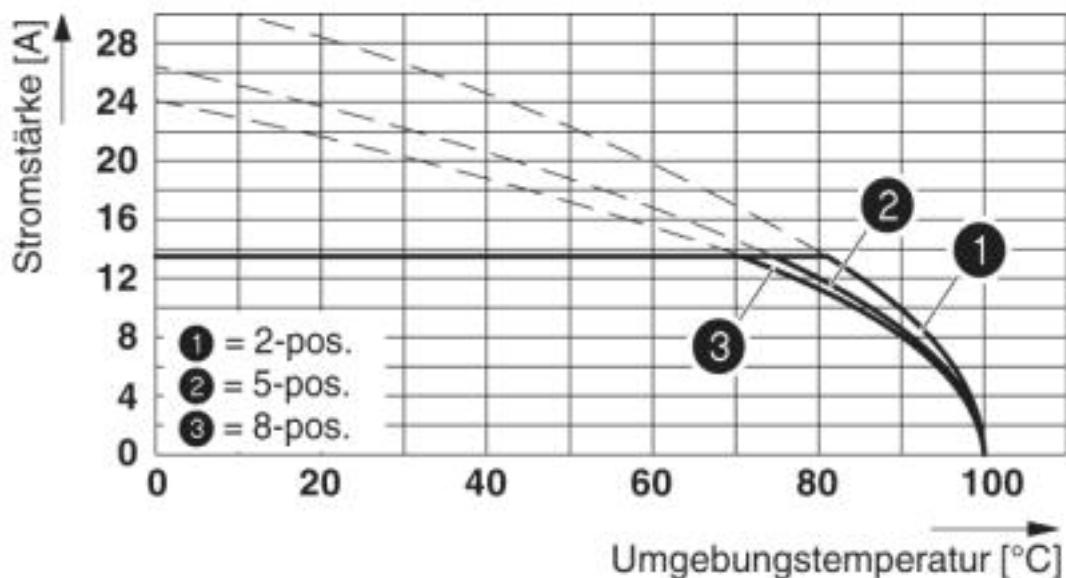
Derating-Diagramm in Verbindung mit Stifteleiste PST 1,3...-LH-5,0;
