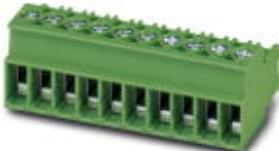
Steckerteil, Nennstrom: 14 A, Bemessungsspannung (III/2): 320 V, Polzahl: 3, Rastermaß: 5 mm, Anschlussart: Schraubanschluss, Farbe: grün, Kontaktobерfläche: Zinn
