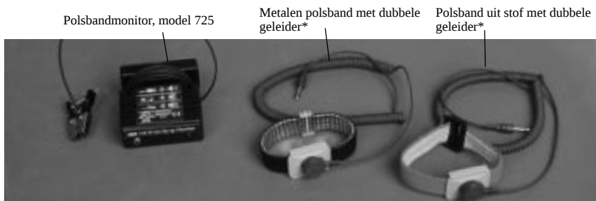
Fig. 1 - Model 725 polsband met polsbanden met dubbele geleider.
