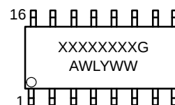
SOIC-16 D SUFFIX CASE 751B
