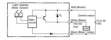
Through-beam receiver E3S-AT41, E3S-AT91 Diffuse reflective E3S-AD41, E3S-AD42, E3S-AD91, E3S-AD92
