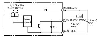
Through-beam receiver E3S-AT21, E3S-AT71 Diffuse reflective E3S-AD21, E3S-AD22, E3S-AD71, E3S-AD72
