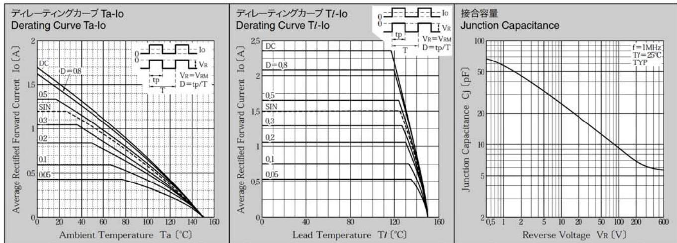
\* Sine waveは50Hzで測定しています。
