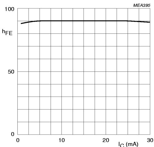
$V_{CE} = 1$  V;  $T_{amb} = 25$  °C.
