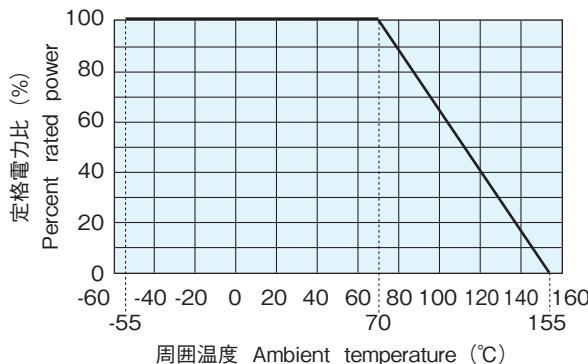
周囲温度70°C以上で使用される場合は、左図負荷軽減曲線に従って、定格電力を軽減して御使用ください。
