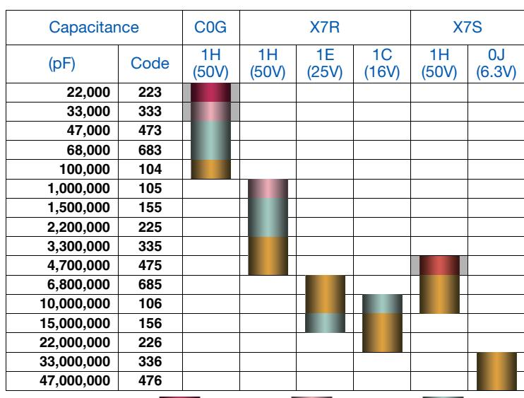
Standard thickness ■ 1.25 mm ■ 1.60 mm ■ 2.00 mm ■ 2.30 mm ■ 2.50 mm
