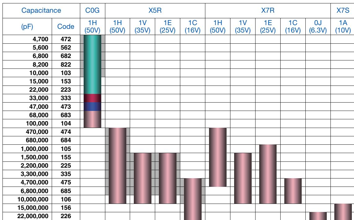
Standard thickness ■ 0.60 mm ■ 0.85 mm ■ 1.15 mm ■ 1.60 mm
