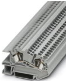
Installationsetagenklemme, Zugfederanschluss, Querschnitt: 0,08 mm 2 - 6 mm 2 , AWG: 28 - 10, Breite: 6,2 mm, Farbe: blau, Montageart: NS 35/7,5, NS 35/15
