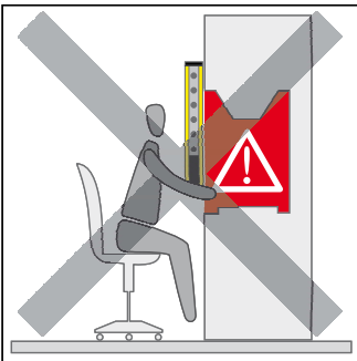
FIG. 22 - 26: ANORDNUNG DER SICHERHEITS-LICHTVORHÄNGE
