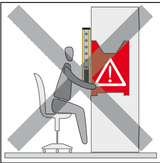
FIG. 12-16: ANORDNUNG DER SICHERHEITS-LICHTVORHÄNGE
