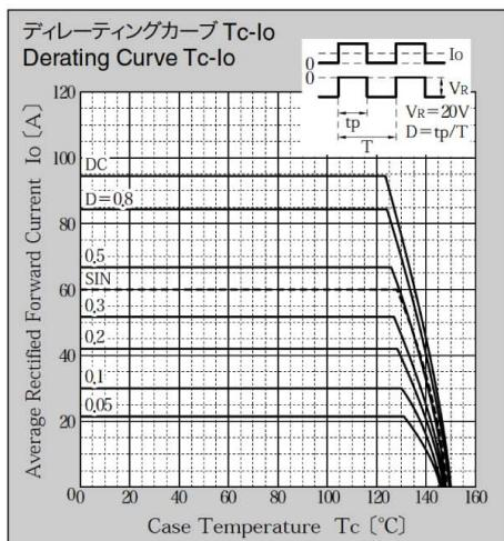
\* Sine waveは50Hzで測定しています。
