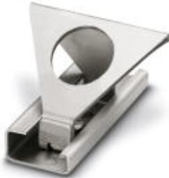
Stützwinkel, als Endabstützung der 70 - 240 mm<sup>2</sup> Klemmen, mit zwei M 6 Schrauben und Muttern, wird 2-fach mit der Tragschiene verschraubt
