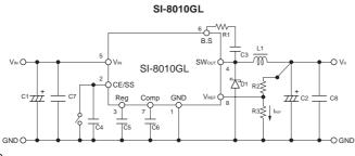
$\begin{array}{cccc} \text{C1: } 220\mu\text{F}/63\text{V} & \text{C8: } 0.1\mu\text{F} \\ \text{C2: } 470\mu\text{F}/25\text{V} & \text{R1: } 47\Omega \\ \text{C3: } 0.1\mu\text{F} & \text{L1: } 47\mu\text{H} \\ \text{C4: } 1000\text{pF} & \text{D1: } \text{RK16} \\ \text{C5: } 0.1\mu\text{F} & \text{(Sanken)} \\ \text{C6: } 0.047\mu\text{F} & \text{C7: } 0.1\mu\text{F} \end{array}$
