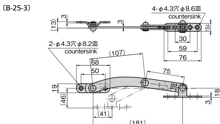
本図は右仕様にセットした図を示す。取付け金具を逆にセットすることにより左仕様となります。
