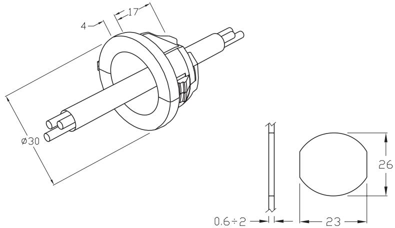
Fissacavo senza vite di fissaggio. Riduzione dei tempi di cablaggio.
