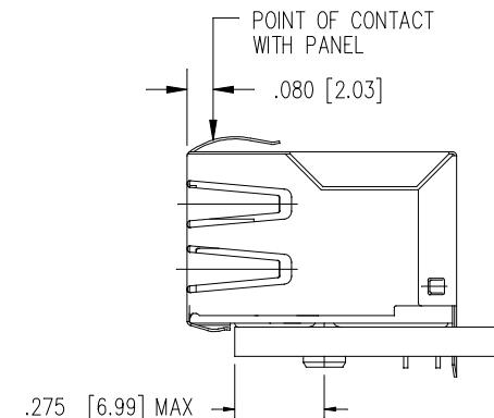
1. THE SUGGESTED PANEL OPENING IS INTENDED TO GIVE THE USER THE ABILITY TO HAVE REASONABLE JACK / PANEL CLEARANCES YET MAINTAIN RELIABLE GROUNDING CAPABILITY.
