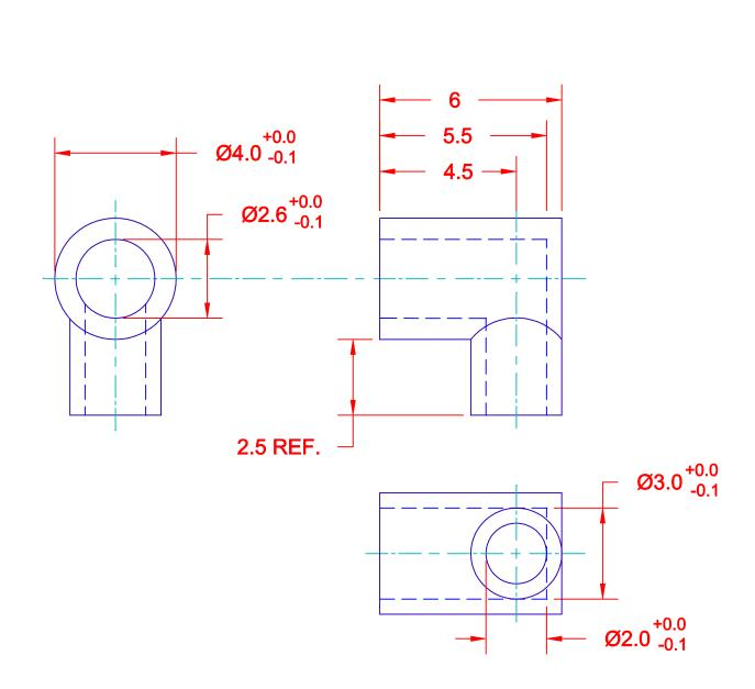
MATERIAL: SILICONE RUBBER UL94V-0
