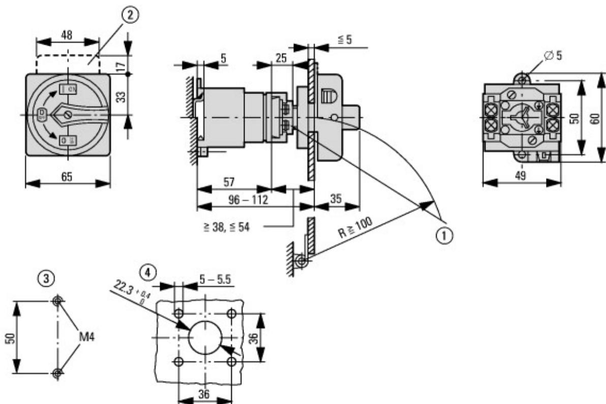
① Rallonge d'axe et de verrouillage possible avec ZAV-T0 + ZVV-T0, max.  $4 \times 25 = 100$  mm
