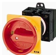
**Interrupteur général, T0, 20 A, Encastrement / Montage encastré avec fixation arrière, 2 Galette(s), 3 pôles + N, Fonctions d'ARRÊT D'URGENCE, Avec poignée rotative rouge et couronne de blocage jaune, verrouillable en position 0**
