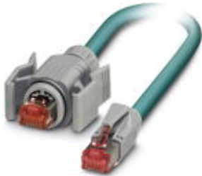
Konfektioniertes Ethernet-Kabel, geschirmt, 4-paarig, AWG 26 flexibel (7-drähtig), RAL 5021 (wasserblau), RJ45-Stecker/IP67, grau auf RJ45-Stecker/IP20, Line, Länge 5 m
