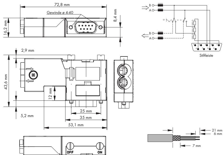
Der Feldbusstecker dient zum Anschluss eines PROFIBUS-Teilnehmers an die PROFIBUS-Busleitung.
