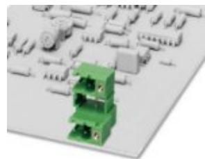
Grundgehäuse, Nennstrom: 10 A, Bemessungsspannung (III/2): 320 V, Polzahl: 3, Rastermaß: 5,08 mm, Farbe: grün, Kontaktobерfläche: Zinn, Montage: Löten, Anreihbar! Befestigungsflansch: Art.-Nr. 1736771, 1736768. Bei Kombination mit MVSTB- oder FKCV-Steckerteilen ist jeweils ein MVSTBW- (bzw. FKCVW-) und ein MVSTBR-Stecker (bzw. FKCVR-) zu verwenden. Kombination mit TMSTBP- Steckerteilen ist nicht möglich!
