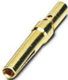
Crimpkontakt, für D-SUB-Kontakteinsätze mit Standard-Kontaktdichte, Buchse, Anschlussquerschnitt AWG 28 ... 24, gedreht, vergoldet
