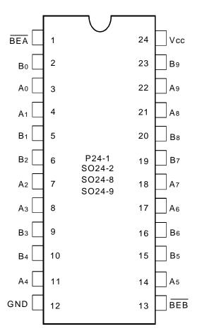
PDIP/ SOIC/ QSOP/ TSSOP TOP VIEW
