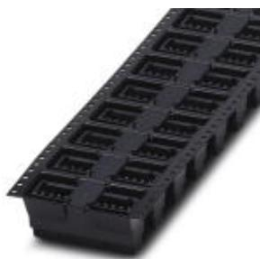
Grundgehäuse, Nennstrom: 4 A, Bemessungsspannung (III/2): 160 V, Polzahl: 3, Rastermaß: 2,5 mm, Farbe: schwarz, Kontaktobерfläche: Zinn, Montage: SMD/THT/THR, Anwenderinformationen und Designempfehlungen zur Through Hole Reflow Technologie finden Sie unter : <http://www.combicon.com>.
