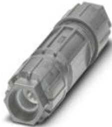
QUICKON Leitungsverbinder, grau, 4-polig ohne PE, 1,0 mm 2 ... 2,5 mm 2 / 630 V / 20 A, für Kabeldurchmesser 6 mm ... 10 mm.
