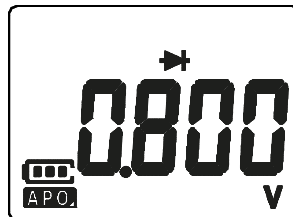
Figura 2-13 Exibição do diodo
