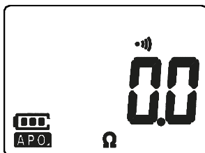
Figura 2-11 Exibição de continuidade fechada
