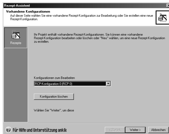
Bild 13-8 Bearbeiten von vorhandenen Rezept-Konfigurationen
