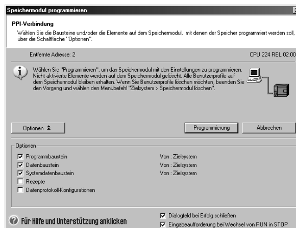
Bild 4-15 Speichern eines Programms im Speichermodul
