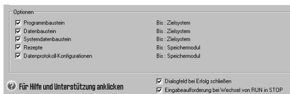
Bild 14-8 Laden von Projekten mit Datenprotokoll-Konfigurationen ins Zielsystem
