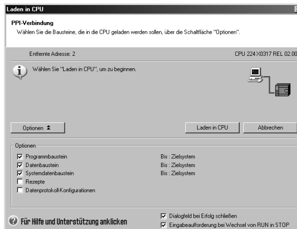
Bild 4-13 Laden eines Projekts in die S7-200 CPU
