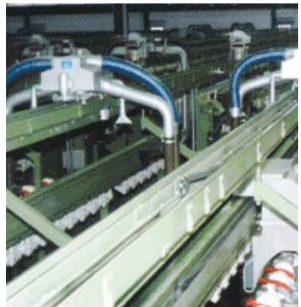
Anwendung bei langen Verfahrswegen bis zu 40 m möglich - Serie 10 hier in einer Textilmaschine
