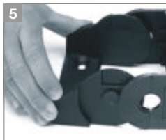
5 Anschlusselement einsetzen und klicken
