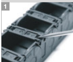
1 Stege aufhebeln und aufschwenken
