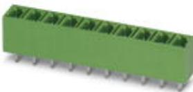
Grundgehäuse, Nennstrom: 8 A, Bemessungsspannung (III/2): 320 V, Polzahl: 10, Rastermaß: 5,08 mm, Farbe: grün, Kontaktobерfläche: Zinn, Montage: Löten
