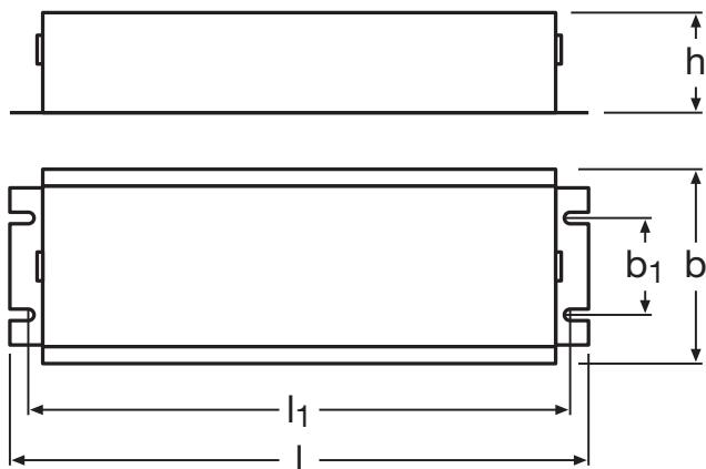
$l = 208\text{mm}$ ,  $l_1 = 195$ ,  $b = 72\text{mm}$ ,  $b_1 = 35\text{mm}$ ,  $h = 38\text{mm}$
