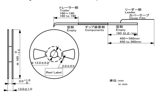
第3図 プラスチックリールの外形寸法図
