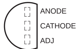
LM336-2.5, LM336B-2.5 . . . LP PACKAGE (TOP VIEW)
