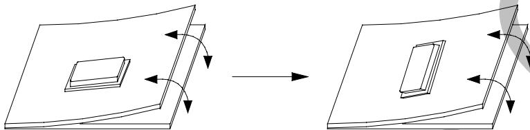
ストレスの作用する方向に対して横向きに部品を配置して下さい。
