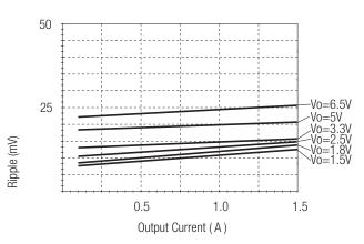
Ripple Vs Load (Vin=Max)
