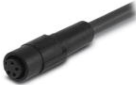
Sensor-/Aktor-Kabel, 3-polig, schwarzgrau RAL 7021, freies Leitungsende, auf Buchse gerade M8 Snap-In, Kabellänge: 2 m
