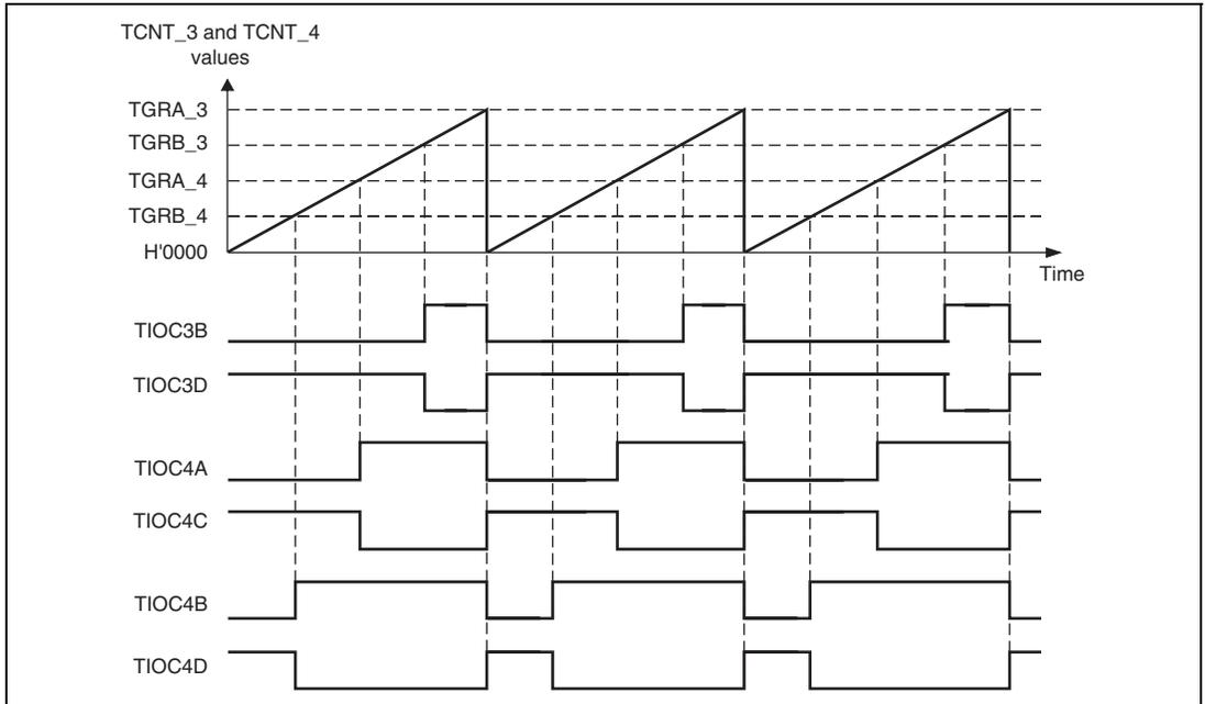
**Figure 9.36 Reset-Synchronized PWM Mode Operation Example**
