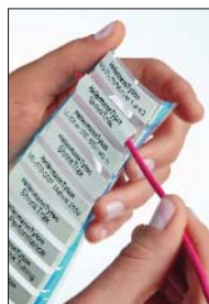
Schritt 2 Applizierten Markierer vom Träger lösen
