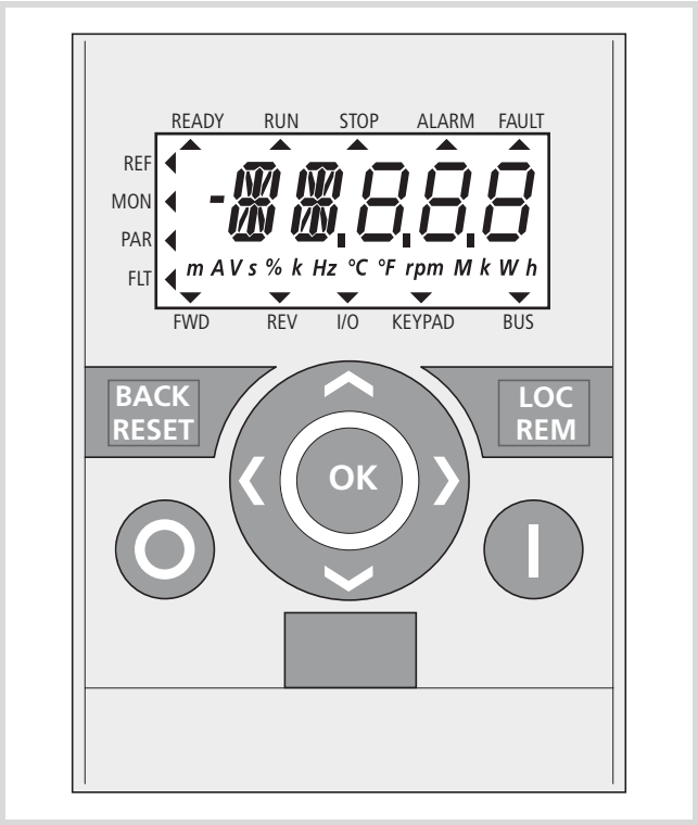
Abbildung 63: Ansicht der Bedieneinheit mit LCD-Anzeige, Funktionstasten und Schnittstelle LCD = Liquid Crystal Display (Flüssigkristallanzeige)
