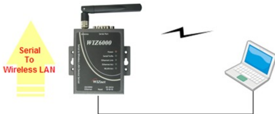
Figure 8. Serial to Wireless LAN 구성
