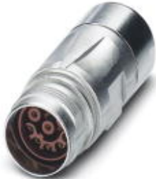
Kupplungssteckverbinder, gerade, SPEEDCON-Verriegelung, M17, Polzahl: 17, Kontaktart: Buchse, Crimpanschluss, geschirmt: ja, Kabeldurchmesser: 9 mm...11 mm
