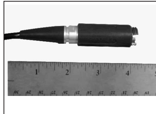
PRO BEAM Mini Plug Connector
