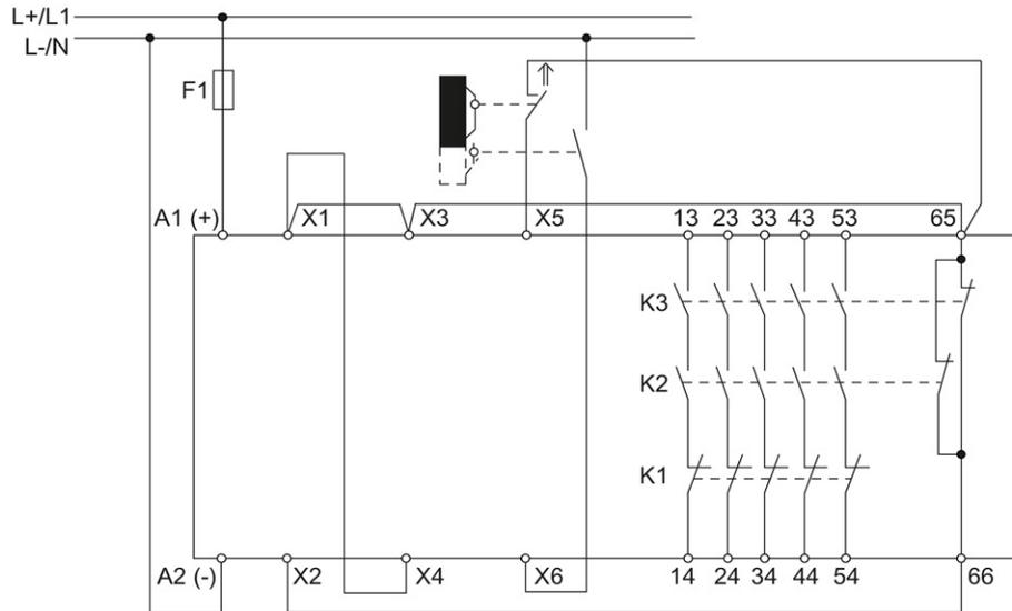
Figure 3-66 Autostart; protective door (2-channel)
