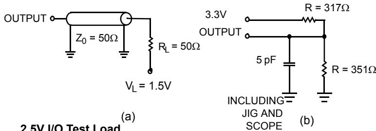
**2.5V I/O Test Load**
