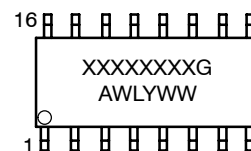
SOIC-16 D SUFFIX CASE 751B
