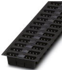
Grundgehäuse, Nennstrom: 12 A, Bemessungsspannung (III/2): 320 V, Polzahl: 2, Rastermaß: 5 mm, Farbe: schwarz, Kontaktoberteile: Zinn, Montage: Gurtverpackte SMD/THT/THR - Bauelemente, Spannung und Strom sind abhängig von der eingesetzten Steckklemme.
